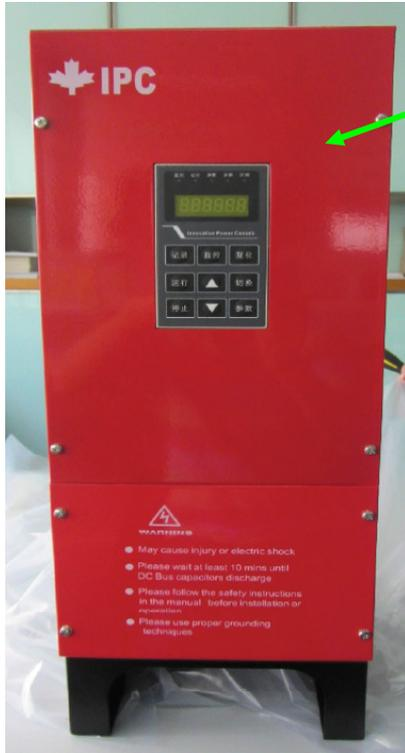
Unter der oberen Abdeckung befinden sich die Anschlüsse für die Kontrollkontakte.
