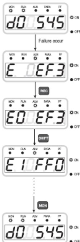
Wenn eine Störung vorliegt wird der aktuelle Fehlercode im Display angezeigt.
