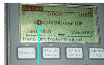
Erhöhen des Drehzahlwertes um jeweils 100 rpm
